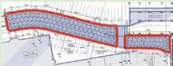
Jet-grouting au niveau du radier suite.
